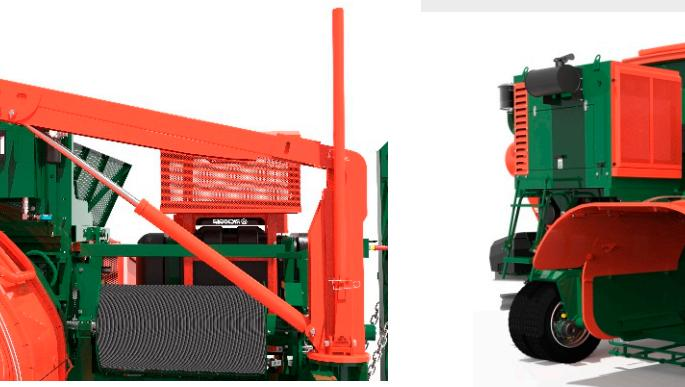
Incorpora una nueva pluma hidráulica de gran capacidad de carga y sencillo manejo, operada por comandos electrohidráulicos que simplifican la tarea de colocación de la bolsa.
