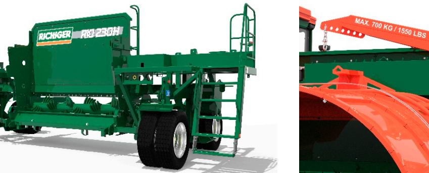
El chasis de la R10 230H es de servicio pesado, con una estructura resistente a la torsión y a las fuerzas generadas por el proceso de compactación del forraje. Esta rigidez estructural asegura el mantenimiento de un perfecto vínculo entre el rotor compactador y el reductor epicicloidal. Los neumáticos 275/80 R22.5 son duales en todos los ejes y brindan excelente desempeño en trabajo y transporte.
