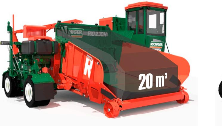
La bandeja de recepción tiene un volumen de 20 m<sup>3</sup> con pantallas de una sola pieza rebatibles, que permiten trabajar con carros compactadores y bateas volcadoras superiores a los 50 m<sup>3</sup>. La cinta transportadora es accionada hidráulicamente por un motor de alto torque con velocidad regulada a través de un comando centralizado. La cinta de alta resistencia posee una textura que logra gran capacidad de transporte de los distintos materiales.
