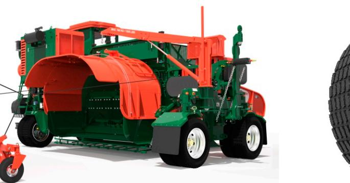
Limiador de túnel accionado hidráulicamente provisto como equipamiento estándar.
